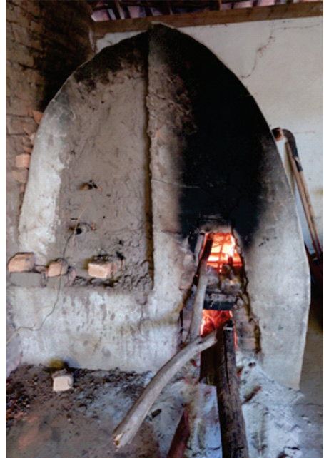
Figura 15 – Forno para queima da cerâmica.
