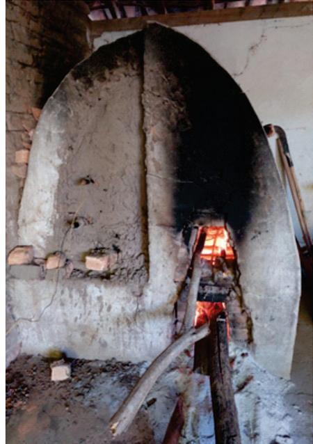
Figura 15 – Forno para queima da cerâmica.
